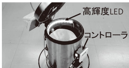
図4 高輝度LEDで牛の敵を誘引・駆除
